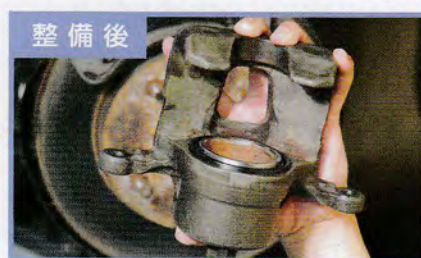
ブレーキ・キャリパから液漏れが無く、ゴム部品が新品の状態
