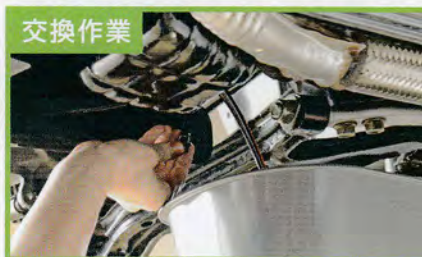
エンジン・オイルをエンジンの下側から抜き取り中
