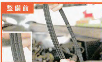
補機ベルトに損傷がある状態（写真は車両から取外した状態）
