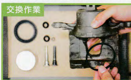
ブレーキ・キャリパを分解清掃し、内部の部品を交換中
