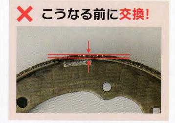
ブレーキ・シューはタイヤと一緒に回るブレーキ・ドラムを内側からおさえつけることによりブレーキを効かせる重要な部品です。ブレーキ・シューには摩擦材が使用されており、使用するうちに摩耗していき、摩擦材が無くなってしまうとブレーキが不安定になり、ブレーキ・ドラムにも損傷を与えてしまいますので、摩耗して残量が少なくなっている場合は交換が必要です。
