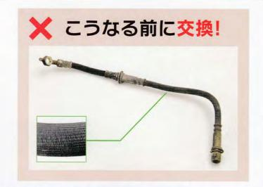
ブレーキ・ホースは、マスタ・シリンダで発生した油圧をブレーキ装置へ伝える重要な役目をしています。ホースはゴム部品であり油圧による伸縮等により経年劣化し、オイル漏れを起こした場合、油圧が発生せずにブレーキの効きが悪くなりますので、適切な時期に交換することが必要です。
