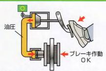
ペダル踏力を油圧に変えてブレーキを作動。
