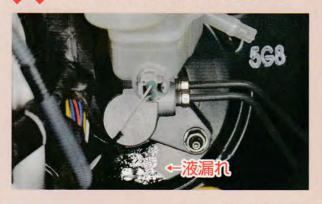
ブレーキ・マスタ・シリンダはブレーキのペダル踏力を油圧に替える働きをしており、内部のピストンには機密性を保つためにゴムシールが使用されています。シール類はゴム部品のため摩擦や油圧による伸縮の繰り返しにより劣化していき、最悪の場合液漏れ等を起こしブレーキの効きが悪くなりますので、適切な時期に交換することが必要です。
