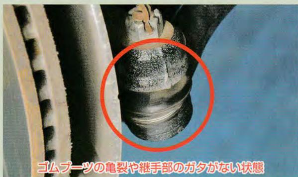
ゴムブーツの亀裂や継手部のガタがない状態
